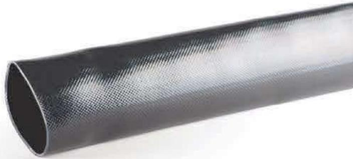
Flach rollbarer, schwarzer Hochleistungs-Gummiflachslauch. Leicht und dünnwandig, innen glatt, außen fein längsgerieft. Einsetzbar für Luft, Frischwasser, Brauchwasser, See- und Schmutzwasser. Aufgrund seiner hohen Verschleiß- und Zugfestigkeit besonders geeignet für besonders schwere Einsätze. Extrem verschleißfest, sowie UV-, witterungs- und ozonbeständig.
