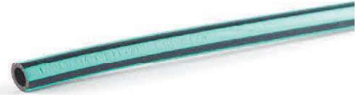
Extrudierter, besonders flexibler Universal-Gummi-Druckschlauch aus hochwertigem EPDM mit Gewebeeinlage. Fett- und LABS-Frei gefertigt, daher besonders gut geeignet als Druckluftschlauch für Farbspritzpistolen. Beständig gegen wasserlösliche Farben, Kunstharzfarben und Polyesterlacke, ketonische Lösemittel, eine Vielzahl von Säuren, Laugen und Chemikalien. Auch geeignet zur Förderung von Wasser und inerten Gasen. Innen und außen elektrisch ableitfähig, Widerstand <math><10^6\Omega</math>.
