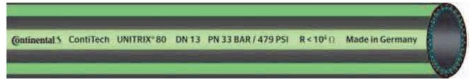
Extrudierter Gummischlauch mit glatter Decke. Komplett trennmittelfrei gefertigter Mehrzweckschlauch. Einsetzbar als Chemie-, Kraftstoff-, Pressluft- und Wasserschlauch.
