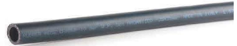
Extrudierter, flexibler Gummi-Druckschlauch mit Gewebeeinlage. Innen und außen glatt. Geeignet zur Förderung von Mineralölen, Benzin, Diesel, E10, sowie tierischen und pflanzlichen Ölen und Fetten. Außen abriebfest, witterungs- und ozonbeständig. (Vormals DWD Art. Gruppe 3555)
