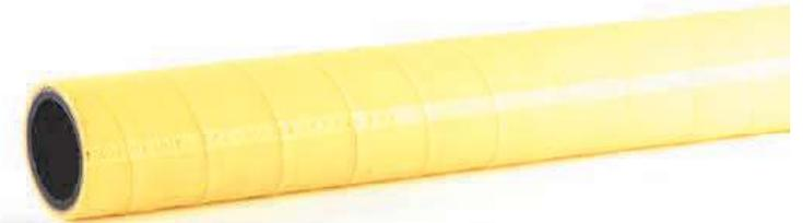
Dorngewickelter Gummi-Druckschlauch mit Gewebeeinlage, robuste Ausführung, besonders widerstandsfähig. Geeignet zur Förderung von Pressluft, sowie Frisch- und Brauchwasser. Ölspure-, witterungs-, ozon- und alterungsbeständig.
