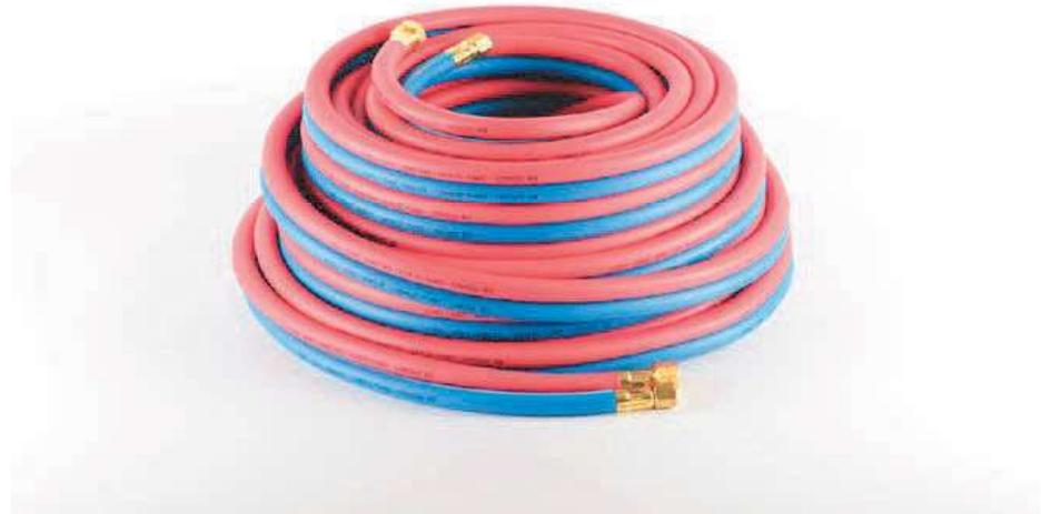
Extrudierter Gummi-Druckschlauch mit Gewebeeinlage. Zusammenvulkanisierter Zwillingssschlauch für die Förderung von Acetylen (außen rot) und Sauerstoff (außen blau) für autogenes Schweißen. Lieferbar als komplett armierte Leitung, beidseits verpresst: Für Sauerstoff Anschlüsse beidseits ¼" Rechtsgewinde, für Acetylen Anschlüsse beidseits 3/8" Linksgewinde.
