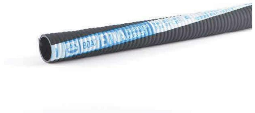
Marine-Abgasschlauch, ein leichter, flexibler Gummispiral- und Druckschlauch, speziell für die Verwendung in Freizeitbooten. Zur Förderung von Abgasen in Verbindung mit Seekühlwasser. Flammwidrig gemäß Spezifikation Nordic Boat Standard MK 9 VTT. Innen und außen wasser-, seewasser- und ölresistent.
