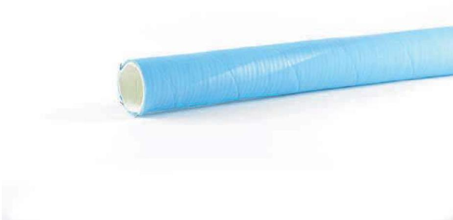
Dorngewickelter Spiralsaug- und Druckschlauch, sehr flexibel, mit weißer, glatter Schlauchseele für Lebensmittel. Besonders geeignet als Milchsammelwagenschlauch. Zu Reinigungszwecken kurzzeitig dämpfbar bis +110°C, außen abrieb- und witterungsfest.
