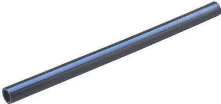
Hochdruckschläuche aus Weich-PVC mit Polyestereinlagen. Mittelschwere Ausführung, knickfest und drallfrei. Geeignet für Luft, Pestizide, leicht alkalische Flüssigkeiten, Frischwasser, Seewasser, ölhaltiges Wasser und Schmutzwasser, witterungs- und ozonresistent. Druckangaben beziehen sich auf +20°C.
