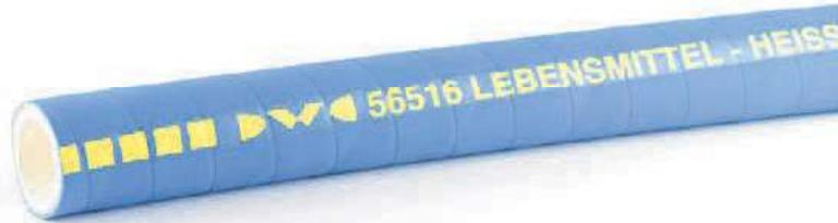
Dorngewickelter Gummischlauch mit Textilgewebeeinlage und Stahlspirale. Außen stoffgemustert, innen glatt. Geeignet als Förderschlauch für flüssige, fetthaltige Lebensmittel, sowie als Reinigungs- und Dampfschlauch.
