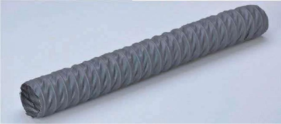
**Flexibler Schlauch aus TPU mit selbsterlöschendem ausgedichtetem Gewebe** und einer eingeschweißten Stahlspirale zwischen den zwei Gewebelagen.
