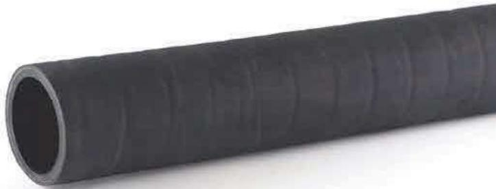
Dorngewickelter Gummi-Druckschlauch mit Gewebeeinlage, abriebfest und elektrisch leitfähig. Geeignet zur Förderung von abrasiven Medien und Schüttgütern wie Zement, Sand, Estrich, Granulate und Kies. Auch geeignet für Wasser, Seewasser und nicht korrosive Flüssigkeiten. Außen witterungs- und ozonbeständig.
