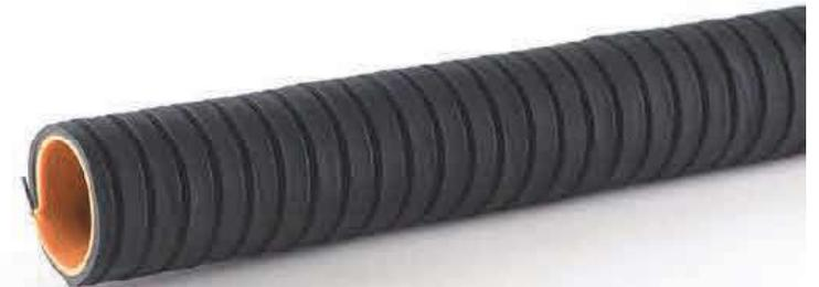
Hochflexibler, dorgewickelter Gummispiralsaug- und Druckschlauch mit einer Seele aus braunem Paragummi und einer blockgerillten Decke. Einsetzbar als Förderschlauch für abrasive Medien, sowie Pulver und Strahlgut.
