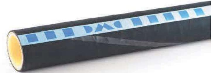
Dorngewickelter Gummisaug- und Druckschlauch mit Gewebereinlage. Geeignet zur Förderung fast aller Chemikalien, Laugen, Säuren, Lösemittel und Kohlenwasserstoffe gemäß Medienliste EN12115. Auch geeignet für Lebensmittel gemäß FDA Titel 21 und BfR. Zu Reinigungszwecken kurzzeitig ausdämpfbar bis +135°C. Schlauchdecke elektrisch ableitfähig.
