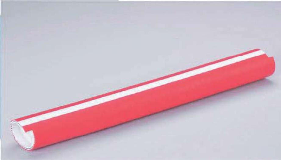
Der Schlauch besteht aus einer TPE-S Mischung mit eingebetteter Federstahlspirale und Gewebeeinlage mit hoher Reißfestigkeit. Der Schlauch kann elektrischleitfähig gemacht werden ( $R < 10^2 \text{ Ohm/m}$ ) durch Erdung der Spirale.
