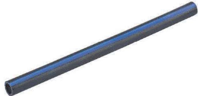
Hochdruckschläuche aus Weich-PVC mit Polyestereinlagen. Schwere Ausführung, knickfest und drallfrei. Geeignet für Luft, Pestizide, leicht alkalische Flüssigkeiten, Frischwasser, Seewasser, ölhaltiges Wasser und Schmutzwasser, witterungs- und ozonresistent. Druckangaben beziehen sich auf +20°C.
