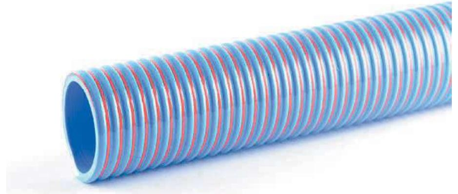
Superelastischer, formstabiler und kälteflexibler Spiralsaug- und Druckschlauch aus Weich-PVC mit Hart-PVC-Wendel. Mittelschwere Ausführung, sehr flexibel. Geeignet für eine Vielzahl von Chemikalien, Frischwasser, Seewasser, ölhaltiges Wasser, Schmutzwasser, Gülle, sowie leicht abrasive Medien. Durch seine Flexibilität und seine mechanischen Eigenschaften ist dieser Schlauch für den Einsatz auf Tankwagen besonders geeignet. Druckangaben beziehen sich auf 20°C.
