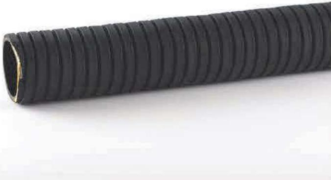
Dorngewickelter Gummisaug- und Druckschlauch mit stoffgemusterter Decke. Von außen blockgerillt, sehr flexible Ausführung. Geeignet zur Förderung von Kühlwasser mit Korrosions- und Frostschutzmittelanteilen. Witterungs-, alterungs- und ozonbeständig.
