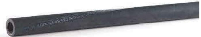
Dorngewickelter Gummi-Druckschlauch mit Gewebereinlage. Hohe Abriebfestigkeit, innen und außen elektrisch ableitfähig. Speziell entwickelt für die Verwendung als Strahlschlauch mit Trockeneis als Strahlmittel.
