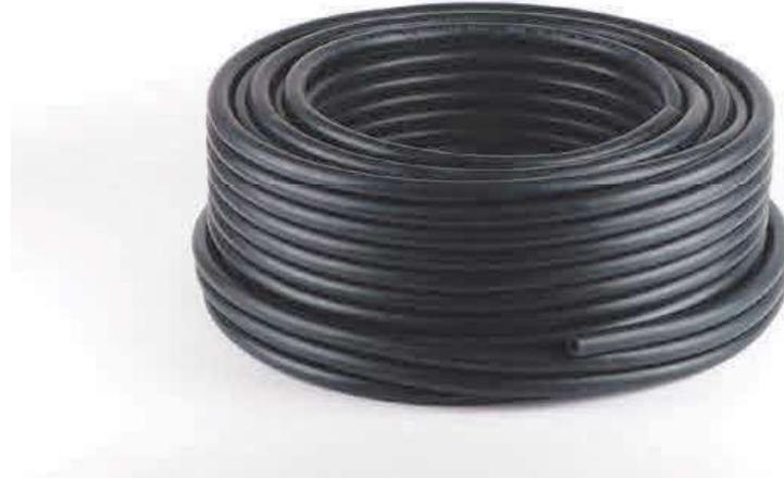
Extrudierter Gummischlauch mit Textileinlage, Ausführung ähnlich DIN 73411/79, aus schwefelvernetztem EPDM. Geeignet für Heißwasser und Kühlwasser mit Korrosions- und Frostschutzmittelanteilen.
