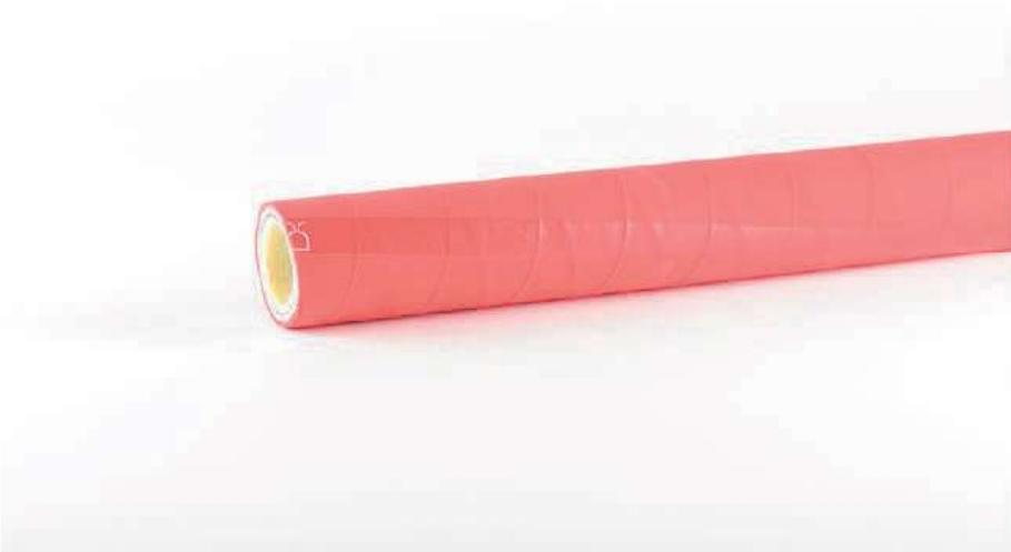
Dorngewickelter Gummi-Druckschlauch mit Gewebeeinlage für fettfreie, flüssige Lebensmittel. Premiumqualität, mit weißer, glatter Schlauchseele. Besonders geeignet für Bier, Wein, Fruchtsäfte und Alkohol bis 96%. Elektrisch leitfähig durch Kupferlitze. Zum Reinigen kurzzeitig dämpfbar bis +130°C.
