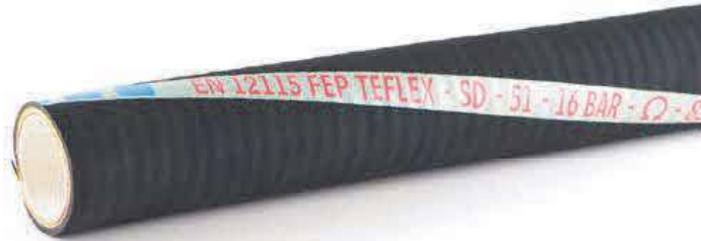
Dorngewickelter Gummispiral- und Druckschlauch mit Gewebeeinlage und Stahlspirale nach EN12115/11. Geeignet zur Förderung fast aller Chemikalien, Säuren, Laugen und Kohlenwasserstoffen auch bei höheren Temperaturen. Auch geeignet für Lebensmittel gemäß FDA Title 21. Schlauchdecke elektrisch ableitfähig (Ω-Typ).
