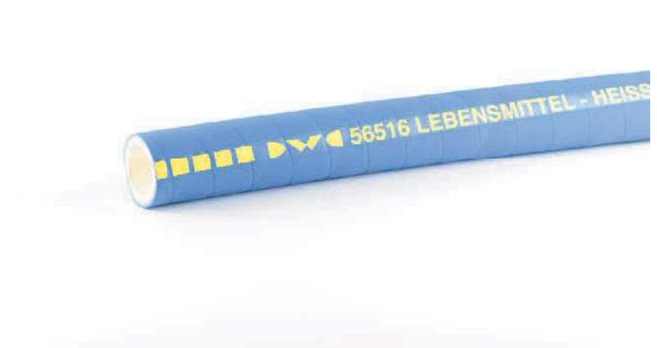
Dorngewickelter Gummischlauch mit Textilgewebeeinlage. Außen stoffgemustert, innen glatt. Geeignet als Förderschlauch für fetthaltige Lebensmittel, sowie als Reinigungs- und Dampfschlauch.
