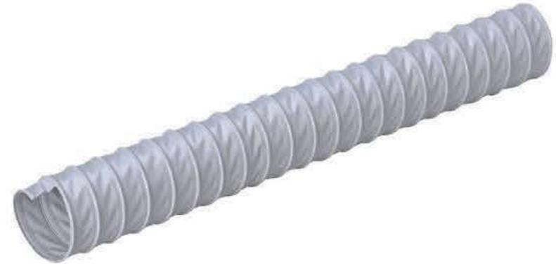
Flexibler Schlauch aus PVC mit selbstlöschendem ausgedichtetem Gewebe, mit einer eingeschweißten Stahlspirale zwischen den zwei Gewebelagen. Der Rohstoff ist selbstlöschend V (TM)-0 nach UL 94 und Grad M2 nach NFP 92 503. Längsstauchbar 8:1.
