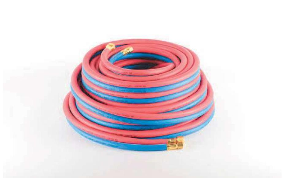
Extrudierter Gummi-Druckschlauch mit Gewebeeinlage. Für die Förderung von Acetylen für autogenes Schweißen. Mit Anschlüssen IG 3/8" links verpresst.
