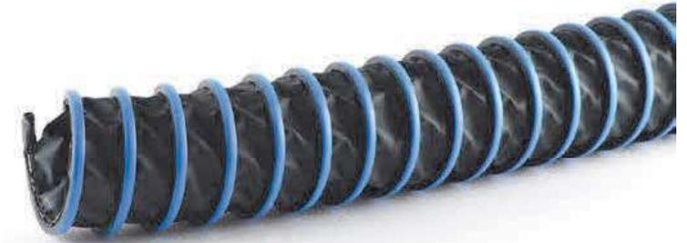
Sehr leichter und äußerst flexibler, verclippter Abgas-Absaugschlauch. Speziell vorgesehen für Deckenschlauchhaspeln in KFZ-Werkstätten. Geeignet zum Absaugen von Abgasen mit mindestens 50% Frischluftzufuhr.
