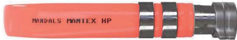
Flach rollbarer Hochdruck-Kompressorschlauch, hergestellt aus zwei Lagen rundgewebtem Polyestergergarn mit einer Innen- und Außenschicht aus thermoplastischem Polyurethan. Ölresistent und sehr abriebfest. Berstdruck 175 bar. Lieferbar in Längen je 20 m und 40 m als Rollenware (ohne Anschlüsse) und als Komplettschlauchleitung mit beidseits eingepressten Stahlverschraubungen RD 65 x 1/6" IG.
