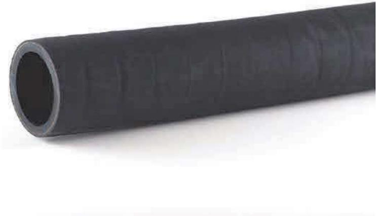
Dorngewickelter Gummi-Druckschlauch mit Gewebeeinlage und besonders dicker Wandung für lange Standzeiten. Geeignet zur Förderung von abrasiven Medien und Schüttgütern wie Sand, Estrich, Granulate und Kies. Außen witterungs- und ozonbeständig.
