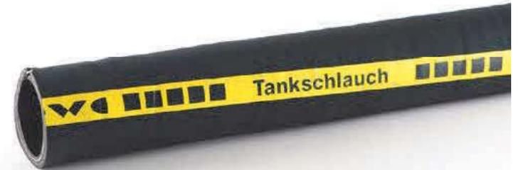
Dorngewickelter Gummispiralsaug- und Druckschlauch mit Gewebeeinlage und Stahlspirale, Ausführung SD nach EN12115:11 für schwere Einsätze. Innen glatt, außen stoffgemustert mit gelber DWD-Farbmarkierung und fortlaufender Prägung. Geeignet für die Förderung von Ölen, Benzin, Diesel, Biodiesel, E10 und weiteren Mineralölprodukten mit einem Aromatenanteil bis 50%. Elektrisch ableitfähige  $\Omega$ /T-Ausführung, auch für Einsätze in Atex-Zonen geeignet.
