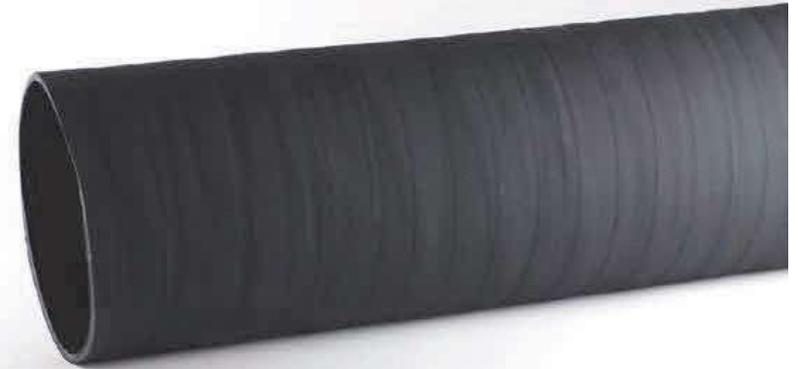
Dorngewickelter Gummi-Druckschlauch mit Gewebeeinlage, knickbar, innen und außen schwarz. Geeignet als Ablaufschlauch an Betonkübeln, Brückenablaufschlauch, Entwässerungsschlauch und vieles mehr. Witterungs- und ozonbeständig.
