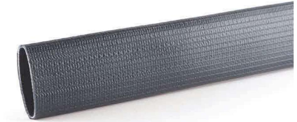
MANTEX ist ein dünnwandiger, leichter, jedoch hochstrapazierfähiger und verschleißfester HD-Kompressor- und Wasserschlauch. Flachaufrollbar, sowie ölbeständig. Mindestberstdruck 100 bar.
