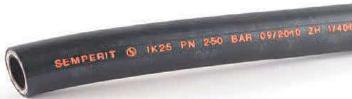
Extrudierter Gummi-Hochdruckschlauch mit geflochtener Gewebeeinlage, schwarz, innen und aussen glatt, abriebfest, wetter- und ozonbeständig. Die Schläuche werden nur mit eingepreßten Armaturen geliefert, eine Seite BSP – AGR, andere Seite drehbare Überwurfmutter DKR. Die Meterpreise verstehen sich inklusive Kupplungen.
