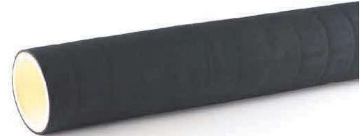
Dorngewickelter Gummi-Druckschlauch mit weißer NR Seele. Elektrisch leitfähig durch Kupferlitzen, vorgesehen für Zucker, Mehl, Getreide, fettfreie, feste Lebensmittel, Granulate und vieles mehr. Außen witterungs- und ozonbeständig.
