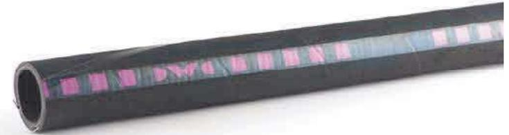
Dorngewickelter Gummissaug- und Druckschlauch, aus hochwertigem EPDM mit Gewebeeinlage und Stahlspirale. Geeignet für Luft, Frischwasser, Seewasser, Säuren, Laugen und eine Vielzahl von Chemikalien gemäß Medienliste EN12115. Geeignet für Einsätze in ATEX-Zonen, Ω/ T- Type, Oberflächenwiderstand  $R < 10^6 \Omega$ , Durchgangswiderstand  $T < 10^9 \Omega$ . Außen öl-, chemikalien-, witterungs-, lichtriss- und ozonbeständig.
