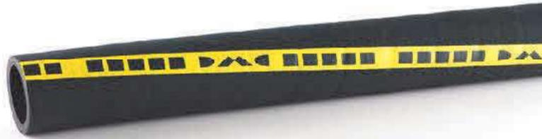
Dorngewickelter Gummi-Druckschlauch mit Gewebeeinlage, Ausführung D nach EN12115:11 für schwere Einsätze. Innen glatt, außen stoffgemustert mit gelber DWD-Farbmarkierung und fortlaufender Prägung. Geeignet für die Förderung von Ölen, Benzin, Diesel, Biodiesel, E10 und weiteren Mineralölprodukten mit einem Aromatenanteil bis 50%. Elektrisch ableitfähige Q/T-Ausführung, auch für Einsätze in Atex-Zonen geeignet.
