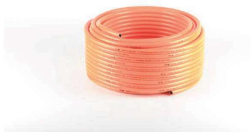
Extrudierter Kunststoffschlauch mit Gewebeeinlage für die Förderung von Flüssiggas nach DIN51622, Propan, Butan und deren Gemische, nach DIN EN16436-1 (vormals DIN4815 Teil 1), DVGW-geprüft mit Registrierungs-Nummer. Nicht geeignet für den Einsatz in gasbetriebenen Fahrzeugen.
