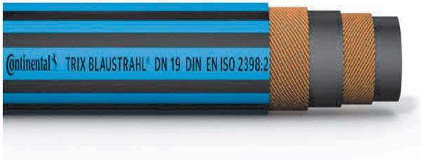
Gummi-Pressluftschlauch nach DIN EN ISO 2398:2010 3C/L\_T, ab DN 28 nach DIN EN ISO 2398:2010 2C/L\_T. Elektrisch leitfähig, komplett trennmittel- und fettfrei. Besonders witterungs- und ozonbeständig. Sehr gute Ölbeständigkeit, RMA Class A. Bis DN25 außen glatt, ab DN28 außen stoffgemustert.
