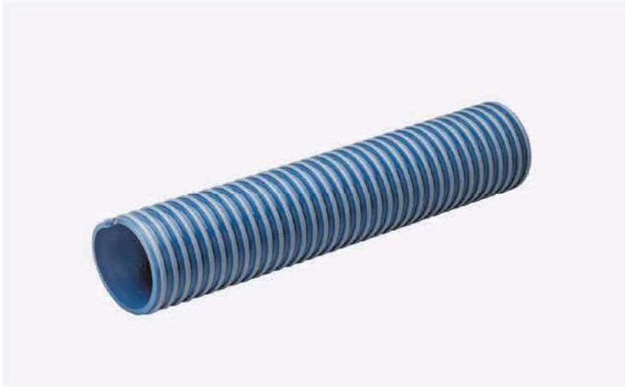
Schlauch aus blauer PVC/NBR Mischung mit herausragendem Außenprofil für ein leichteres Gleiten auf allen Oberflächen. Der Schlauch ist extrem flexibel, auch bei niedrigen Temperaturen. Der Schlauch ist einsetzbar als Druck- und Saugschlauch für Mineralöle, Schmiermittel, Erdöl, Abwasser aller Art und Gülle.
