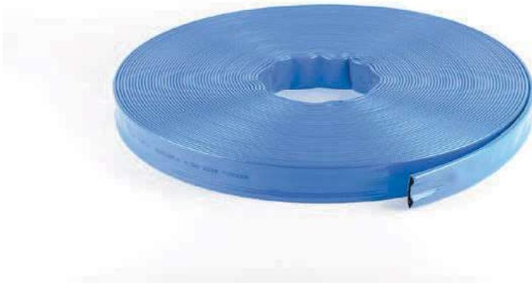
Flach rollbare PVC-Schläuche aus Weich-PVC, innen schwarz, außen blau, mit Polyester einlage. Geeignet als Druckschlauch für Flüssigkeiten. Geeignet als Zu- und Ablaufschlauch in der Landwirtschaft, Bauwirtschaft und Industrie. Resistent gegen atmosphärische Einflüsse, Chemikalien und Ölsuren. Druckangaben beziehen sich auf +20° C.
