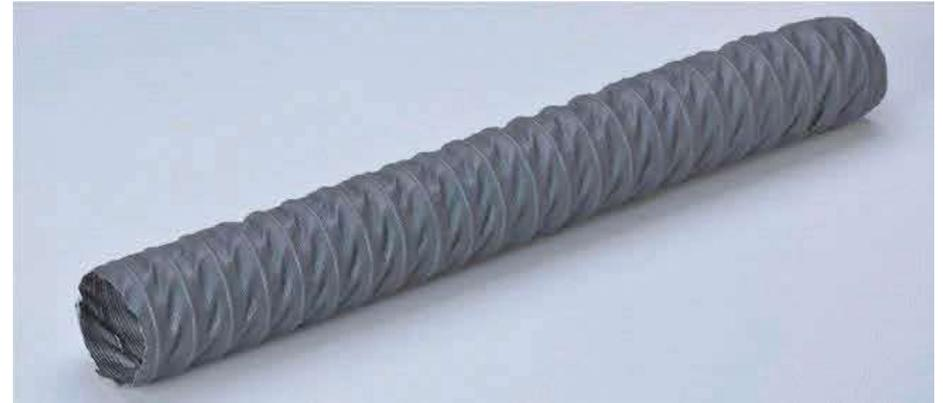
Flexibler Schlauch aus TPU mit selbsterlöschendem ausgedichtetem Gewebe, und einer eingeschweißten Stahlspirale zwischen den zwei Gewebelagen. Der Rohstoff ist selbstlöschend V(TM)-0 nach UL 94, Grad M1 nach NFP 92503 und Grad FAR25-853-a nach NF EN 2310.
