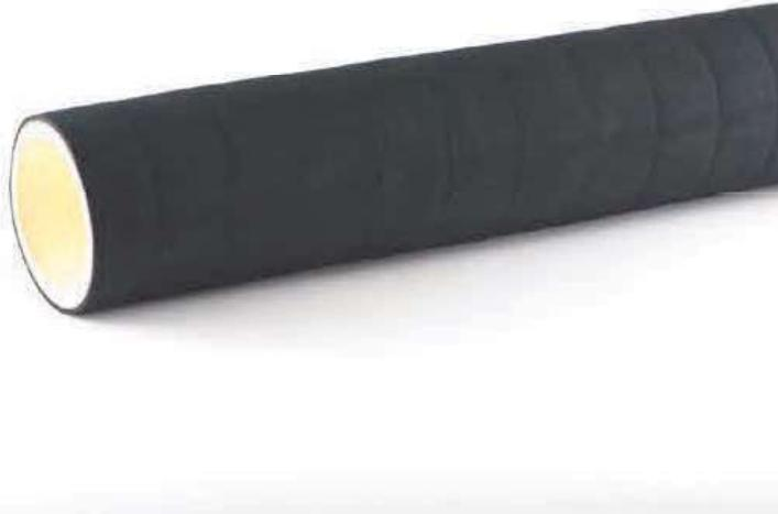
Formstabiler Gummispiralsaug- und Druckschlauch. Elektrisch leitfähig durch Kupferlitzen. FDA-konform, vorgesehen für Zucker, Mehl, Getreide, fettfreie, feste Lebensmittel, Granulate und vieles mehr. Außen witterungs- und ozonbeständig.
