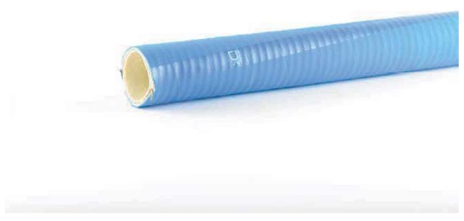
Dorngewickelter, leichter und sehr flexibler Gummisaug- und Druckschlauch mit Gewebeeinlage und Stahlspirale für die Nahrungs- und Genussmittelindustrie. Besonders geeignet für Wasser, Bier, Wein, Fruchtsäfte, hochprozentigen Alkohol und weitere fettfreie, flüssige Lebensmittel.
