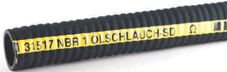
Ein sehr flexibler Leicht-Tankwagen Gummispiralsaug- und Druckschlauch. Geeignet zur Förderung von Ölen und Kraftstoffen mit einem Aromatenanteil bis 50%. Innen glatt, außen gewellt mit gelber DWD-Markierung, elektrisch ableitfähige Qualität, elektrischer Widerstand <math>< 10^9 \Omega</math>.
