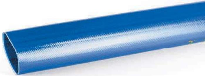
Flach rollbarer, blauer Polyurethanschlauch, innen und außen von hoher Verschleißfestigkeit, mit rundgewebten Polyesterreinlagen. Vorgesehen und zugelassen für die Förderung von Trinkwasser, als mobile Versorgungsleitung, Trinkwassernetzleitung oder Trinkwasserversorgungsleitung auf Volkfesten.
