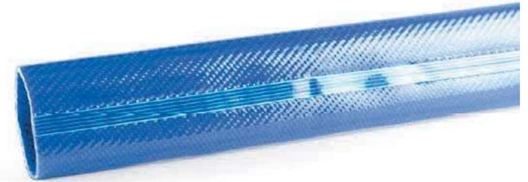
Flach rollbarer, blauer Polyurethanschlauch, innen und außen von hoher Verschleißfestigkeit, mit rundgewebter Polyesterreinlage für höchste Zugfestigkeit. Vorgesehen für die Trinkwasserförderung aus Tiefbrunnen, mit aufvulkanisierten Schlaufen zur Kabelbefestigung.
